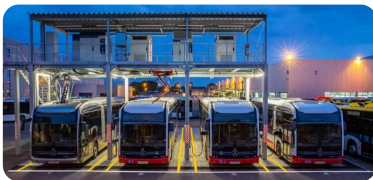
Nočné nabíjanie v depe v meste Mannheim oboma typmi rýchlonabíjacích staníc (Zdroj: Mercedes-Benz)
