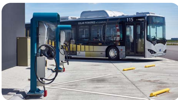
Cestný spomaľovací prah pre uľahčenie pristavenia vozidla (Zdroj: Letisko Schiphol, Amsterdam)
