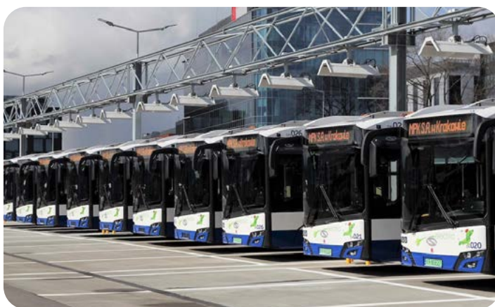
Paralelné parkovanie v depe s pantografovým nabíjaním v meste Krakov (Zdroj: Solaris)
