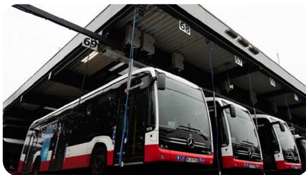
Umiestnenie CCS nabíjacej stanice pod prístreškom so zveseným nabíjacím káblom v depe mesta Hamburg (Zdroj: Hamburger Hochbahn)
